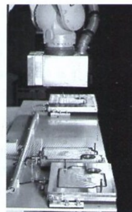
Transport van onderdelen m.b.v. een vacuümgreijper
